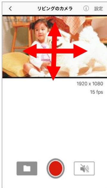
画面を上下左右にフリック操作することでカメラの向きを操作することができます。（水平方向：320°／垂直方向：35°）画面をピンチ操作するとズームイン・ズームアウトができます。周囲が暗くなると自動で暗視モードに切り替わります。
