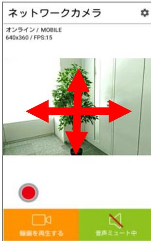
画面を上下左右にフリック操作することでカメラの向きを操作することができます。（水平方向：320°／垂直方向：35°）
