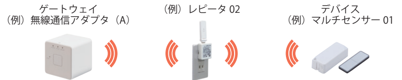
ゲートウェイとデバイスの中間付近のコンセントに設置
